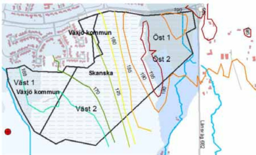
Figur 17, Delavrinningsområden och höjdkurvor. Väst leder till Rinkabydiket och Öst till östra diket
